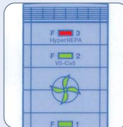
**Monitoraggio della durata del filtro** – calcola quando è ora di sostituire il filtro, tenendo conto dell'utilizzo, della velocità della ventola e dei livelli di inquinamento programmati.
